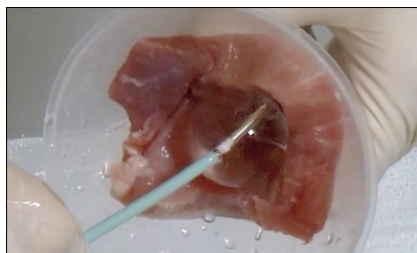
バルーン押し付けの様子 生理食塩液の水槽内で通電加熱 条件：温度設定 70℃、焼灼時間3分
